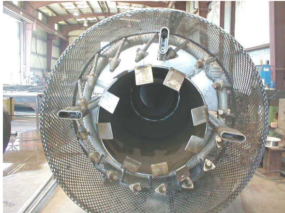
شکل ۲-۱۱. نمونه از یک فلر بدون دود بخار کمک برای ظرفیت های پایین
