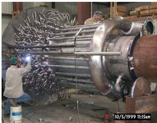
شکل ۲-۱۲. نمونه از یک فلر بدون دود بخار کمک برای ظرفیت های بالا
