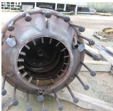
شکل ۲-۷. استفاده از نازل های تزریق بخار در فلر برای بهبود راندمان احتراق
