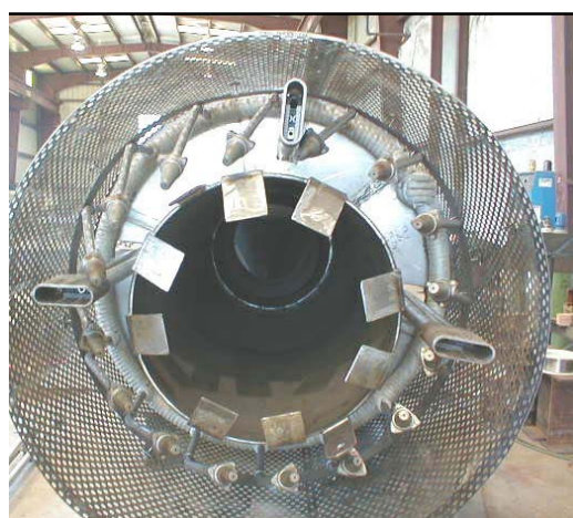
شکل ۲-۷. استفاده از نازل های تزریق بخار در فلر برای بهبود راندمان احتراق
