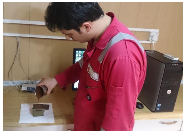
شکل 10: انجام تست مقاومت تراکمی برای دوغاب PCF 145 مایکرومکسی
