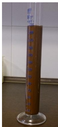
شکل 11: بررسی ته‌نشست و تعیین مقدار آب آزاد دوغاب PCF 145 مایکرومکسی
